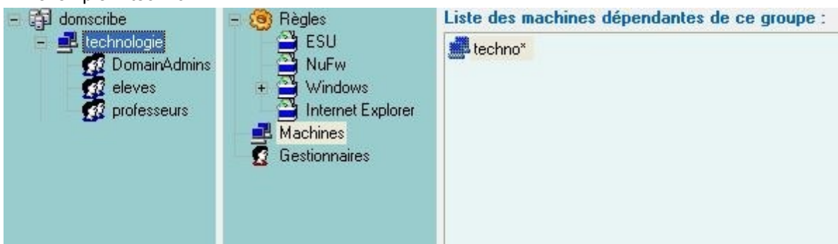
Écran 100 Utilisation du jocker (*) pour paramétrer les noms de machines prises en compte par le groupe
